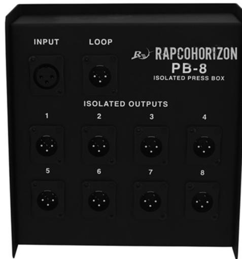
Die PB-8-Pressebox eignet sich perfekt für Pressekonferenzen oder alle Situationen, in denen ein einzelnes Mikrofonsignal mehrfach „aufgeteilt“ werden muss. Zu seinen Merkmalen gehören ein robustes Stahlgehäuse, ein einzelner weiblicher XLR-Mikrofonpegeleingang, ein „Loop“-Ausgang (für die „Daisy-Chain“-Verbindung mit einer weiteren PB-8 für zusätzliche Ausgänge) und acht diskrete Transformer isolierte XLR-Steckerausgänge. Die Anschlüsse sind versenkt, um Beschädigungen zu vermeiden.
